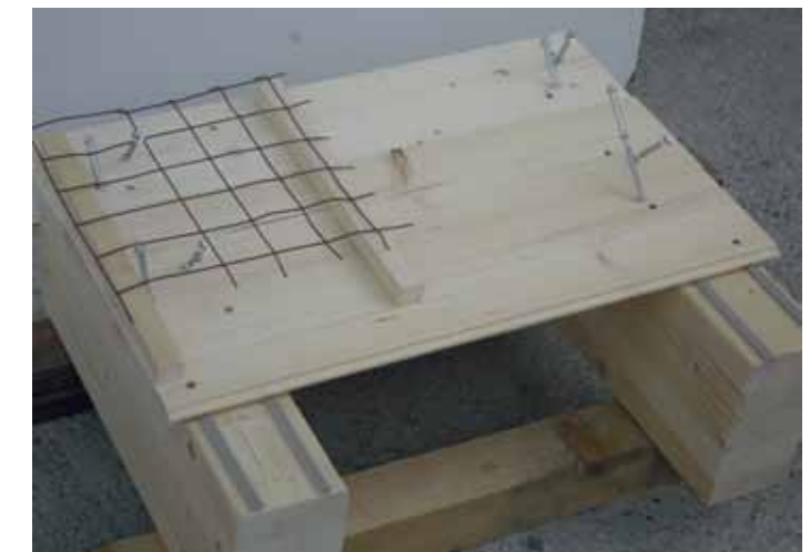
Piolatura a secco con viti SFS accoppiate
